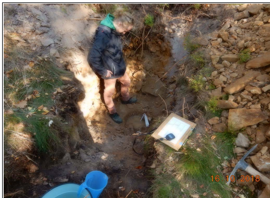
Abb: 4: Schurf 1. Versickerungsprüfung SV 1 auf der Schurfsohle
