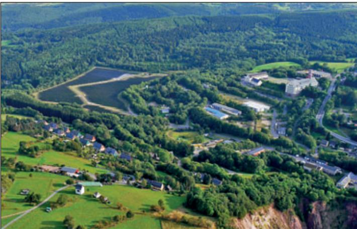
Abb. 13 Nachnutzung der Tiefenbachhalde mit einer Photovoltaikanlage mit einer Gesamtleistung von 10MWp (09/2020).
